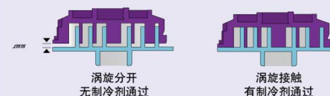
图4 谷轮数码涡旋™压缩机调节机制
